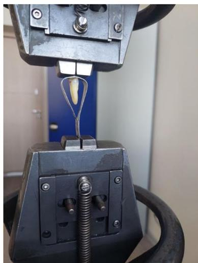
Рисунок 12 – Анализ силы адгезии с применением разрывной машины (Tinius Olsen H150KU)
